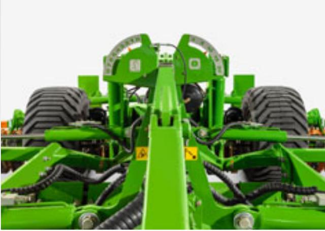
Affichage de la profondeur de travail du crushboard (à gauche) et du compartiment de disques (à droite)
