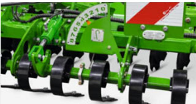
Crushboard avec réglage hydraulique de profondeur et échelle graduée bien lisible
