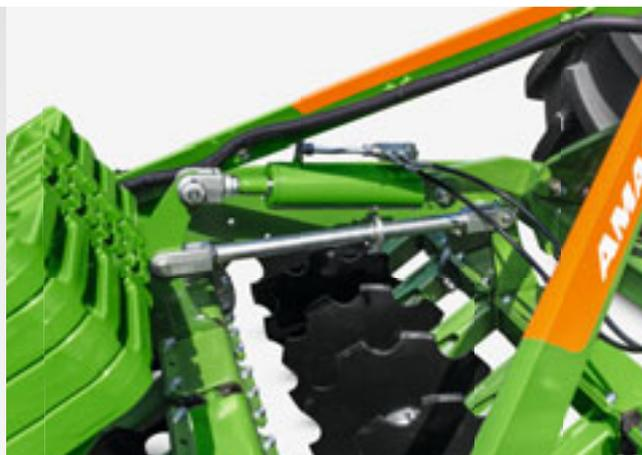
Réglage hydraulique de la profondeur de travail
