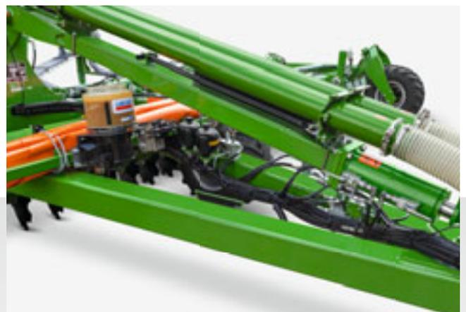
Système de graissage central sur le Catros<sup>+</sup> 12003-2TS
