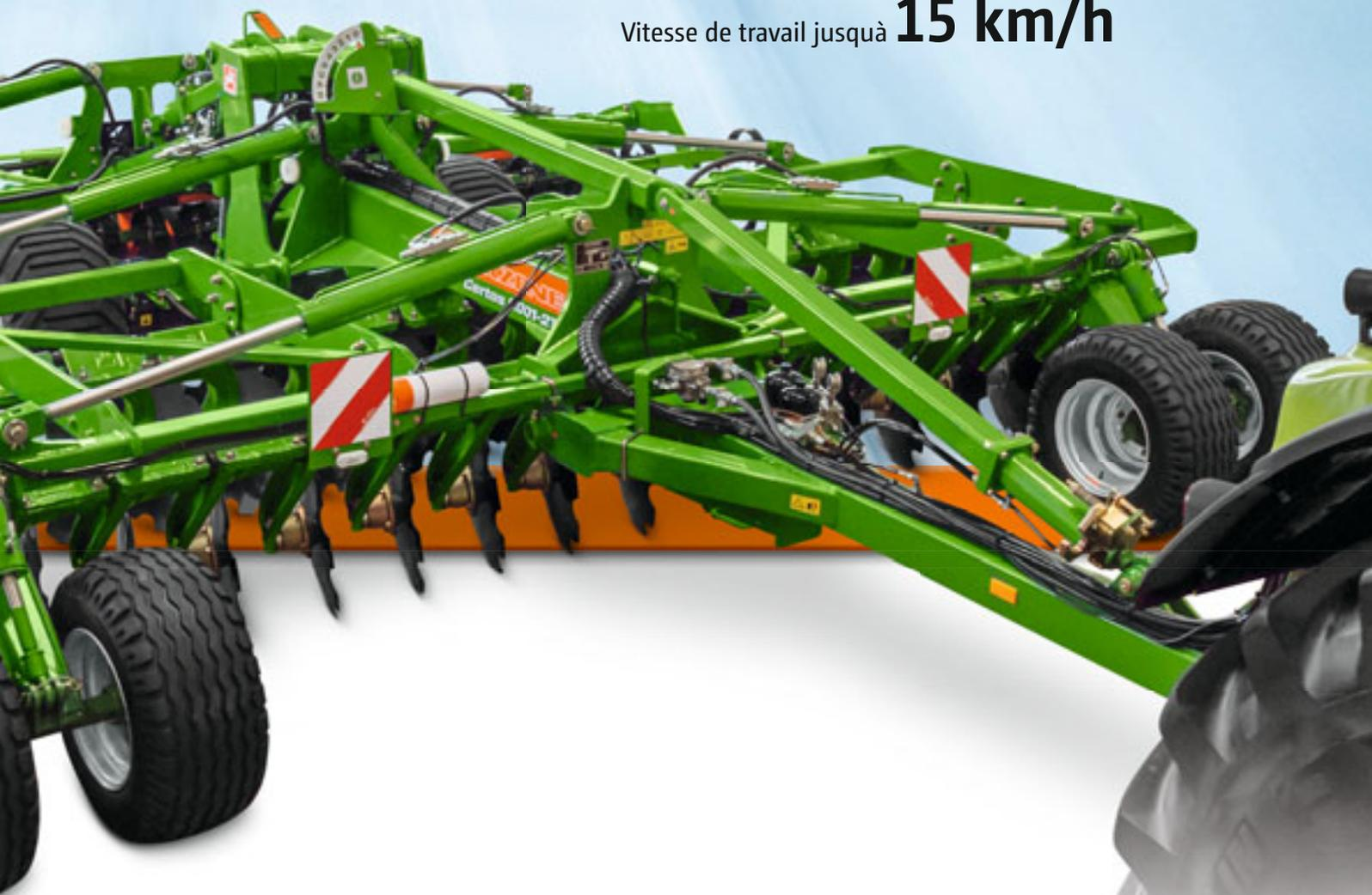
Le déchaumeur à disques traîné Certos-2TX est idéal pour un mélange intensif et un travail jusqu'à une profondeur moyenne. Avec ses grands disques de 660 mm, le Certos-2TX pénètre jusqu'à une profondeur de 20 cm dans le sol et travaille aussi des volumes importants de masses organiques, sans aucun risque de bourrage. Grâce à son vaste spectre de travail, le Certos-2TX avec ses largeurs de travail de 4 m à 7 m est une machine polyvalente qui convient à toutes les exploitations.
