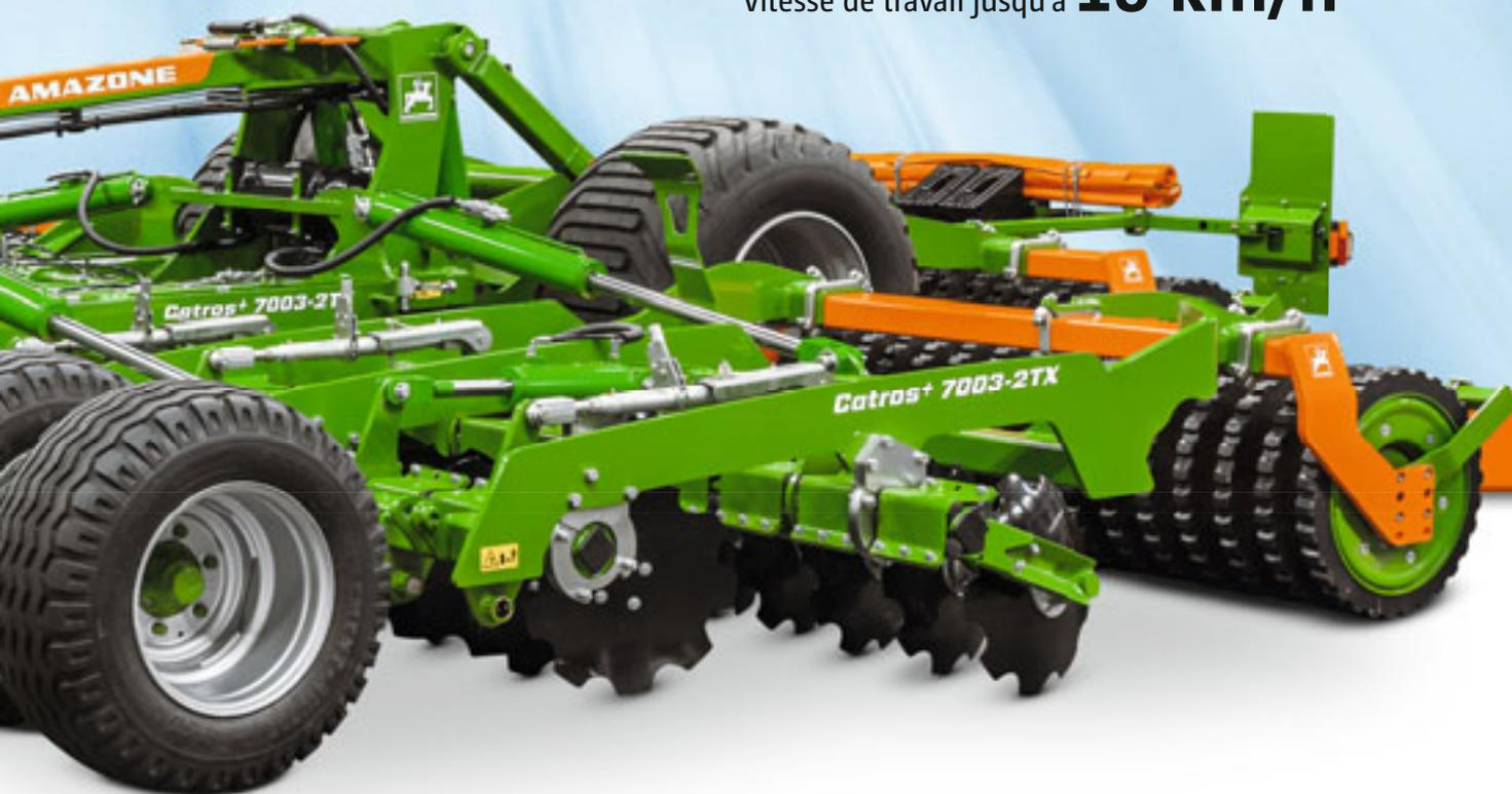
Le déchaumeur à disques traîné Catros-2TX est idéal pour la préparation superficielle du sol avec une incorporation intensive. Le chariot central confère à la machine une maniabilité exceptionnelle et permet des déplacements routiers sûrs et rapides, malgré les largeurs de travail de 7 m à 9 m. La régularité de progression exceptionnelle et la facilité de traction garantissent un confort de conduite maximal pour un rendement exceptionnel.
