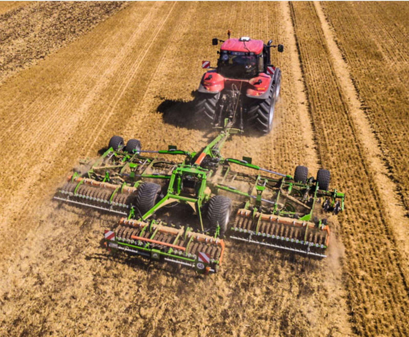
Catros<sup>+</sup> 8003-2TX avec rouleau rayonneur et pneus à profil Matrix en largeur de travail 8 m
